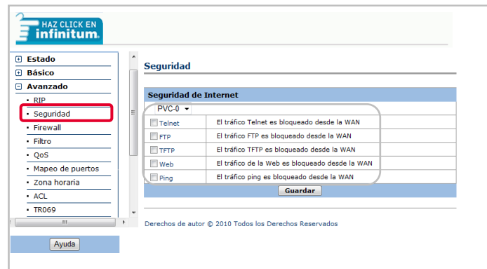
Figura 21. Validando las opciones de seguridad en el MODEM.
