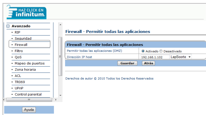
Figura 23. Ingresando IP local en DMZ.
