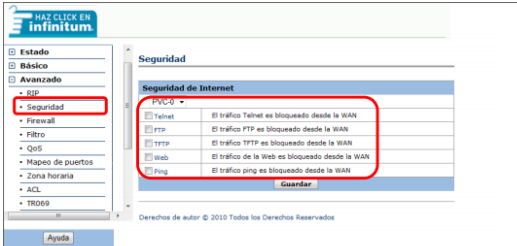
Figura 18. Validando las opciones de seguridad del modem.
